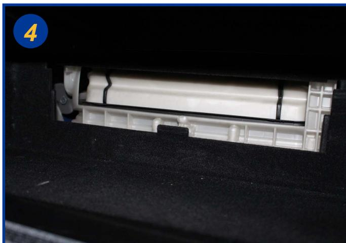
Le boîtier filtrant est fermé électriquement, ne pas forcer pour l'ouvrir. (voir photos 5 pour activer son ouverture).
